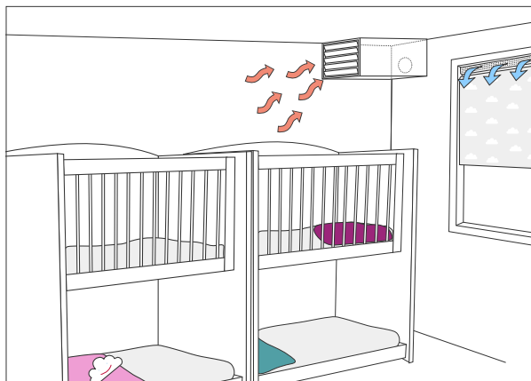
KVB-200 met afvoer naar gevel
